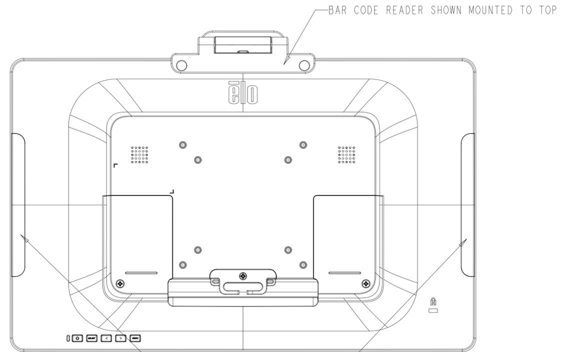
SCANNER HEAD ROTATES 180 DEGREES
